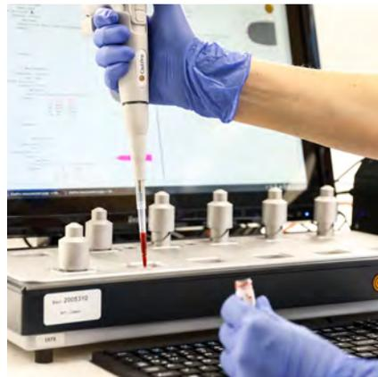
6-Kanal Viskoelastometrie-Analyser ermöglicht schnelle Analyse der Vollblutgerinnung
